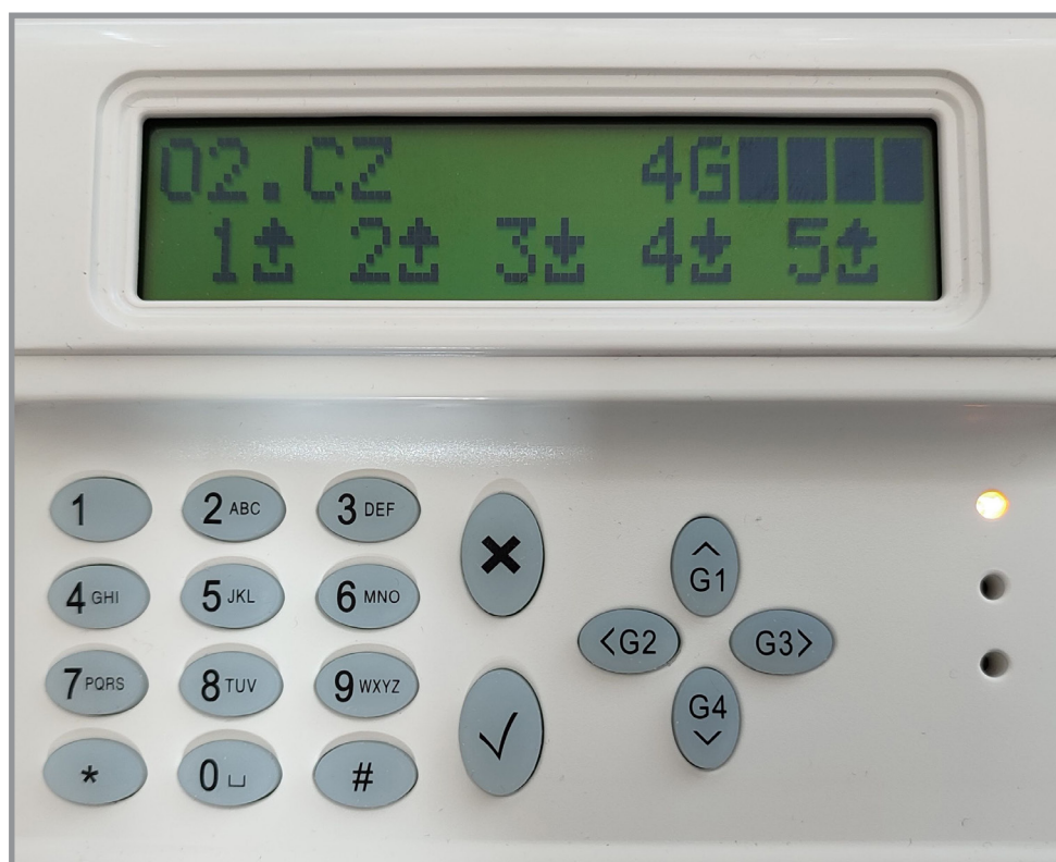
Příklad GSM modulu VOX-4W v provozu. Terminály 1, 2, 5 zde nakonfigurovány jako výstupy, terminály 3 a 4 jako vstupy.
